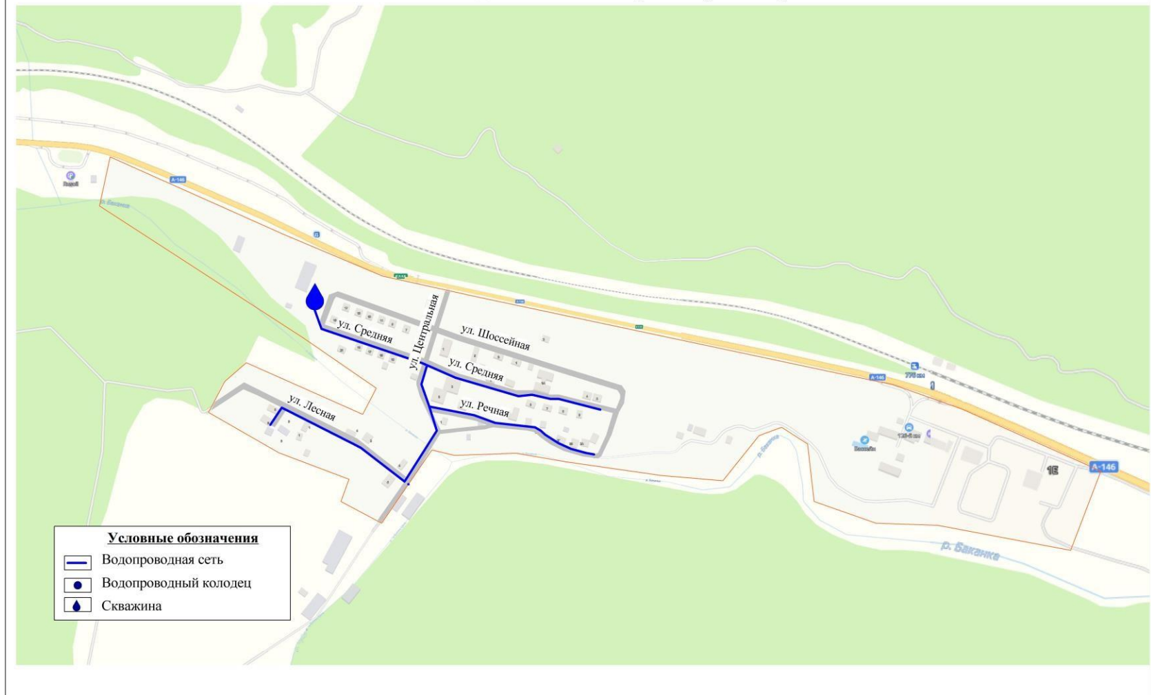
Рис. 3 - Схема водоснабжения п. Жемчужный Крымского района
